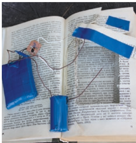
Спеціально встановлений вибухонебезпечний підривний засіб, (міна-пастка) замаскований в банки з-під кави та книжку
