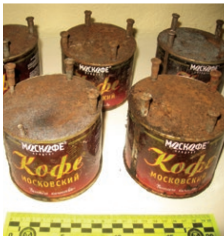
Спеціально встановлений вибухонебезпечний підривний засіб, (міна-пастка) замаскований в банки з-під кави та книжку
